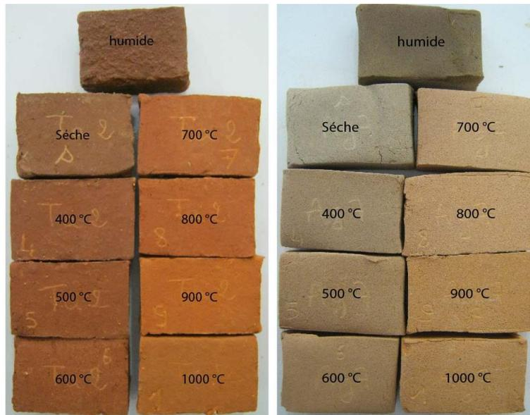
Figure V-17 : Variation de la couleur de deux pâtes humides cuites jusqu'à 1000°C dans un four électrique ; à droite, pâte à teneur élevée en chaux (sédiment de N'Fis) ; à gauche, pâte dépourvue de chaux (colluvions de Talatast).
