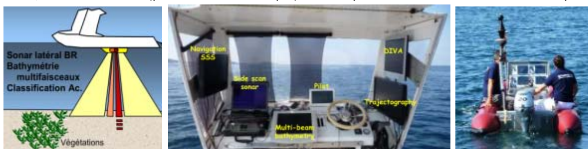
Figure 19 : Plates-formes légères de sondage multi-capteurs : Principe - Poste de pilotage - Mini Navire Océanographique
