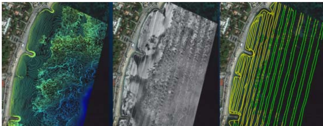
Figure 20 : De gauche à droite : (A) Isobathes (micro-rugosité bathymétrique) - (B) Imagerie sonar latéral (C) Classification acoustique (Détection végétation en vert - Sédiment en jaune). Taille des zones : 500 m par 300 m
