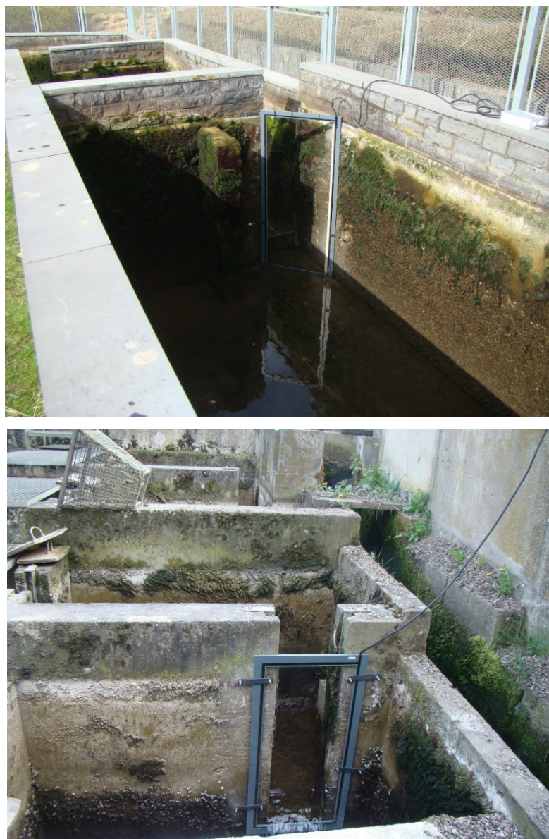
Figure 4. Au-dessus : antenne de détection RFID placée au niveau d'une échancrure à l'amont de la grande échelle à poissons de Lixhe sur la Meuse. En dessous : antenne de détection RFID placée au niveau d'une échancrure à l'amont de la petite échelle à poissons de Lixhe sur la Meuse.
