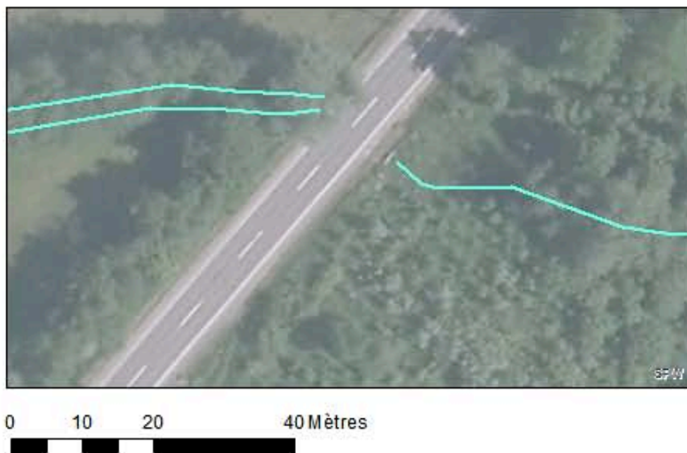
Figure 14 – Interruption de la cartographie d'un cours d'eau dans le PICC sur sa portion passant sous un pont
