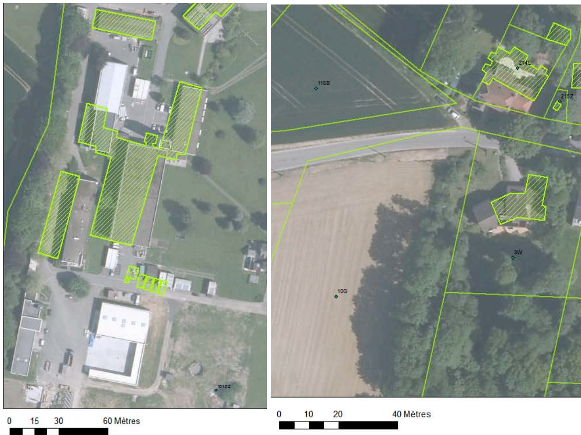
Figure 9 – Décalage entre le plan cadastral (ici représenté en par les contours verts) et un orthophotoplan.
