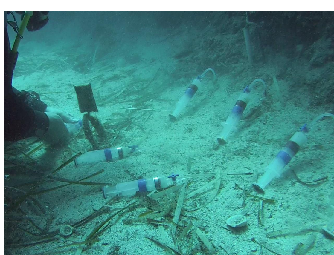
Figure 7 : prélèvement de l'eau interstitielle du sédiment
