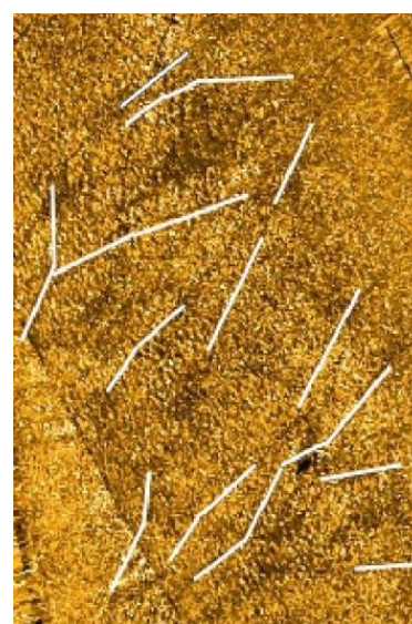
Figure 22 : sillons d'ancrages (matérialisés en blanc) apparaissant sur le sonogramme de 2010 au niveau de l'Alga.
